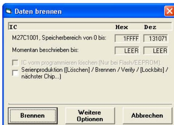
5. Nach dem Klick auf „Brennen“ startet der Brennvorgang und Sie sehen eine Statusanzeige. Nach dem Brennvorgang werden die Daten erneut eingelesen und Bitweise verglichen. Nachdem das Einlesen der Daten aus dem Chip und der Vergleich der Daten des Chips mit den zu brennenden Daten erfolgreich abgeschlossen wurde, ist der Chip fertig und Sie können ihn entnehmen.
